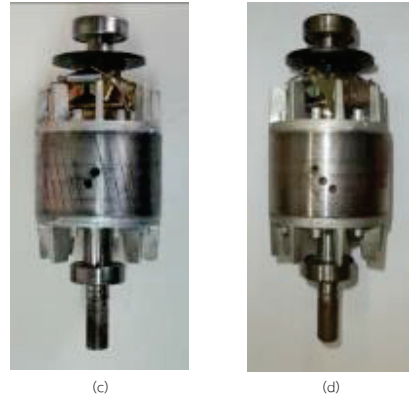
รูปที่ 7 โรเตอร์ที่ใช้ในการทดลองกรณีตัวนำโรเตอร์แตก (a) HT (b) 1BB (c) 2BB (d) 3BB
