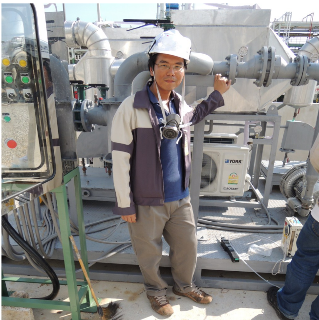
โครงการใช้เทคนิคสกัดไอดิน (Soil Vapor Extraction) ในการฟื้นฟูดินปนเปื้อนสารอินทรีย์อันตรายประเภทสารอินทรีย์ระเหยในพื้นที่มาบตาพุด
